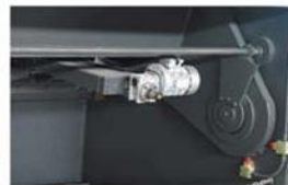
手动调节刀片间隙 ручное регулирование промежуток инструмента
